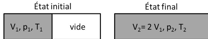
Figure 4 : Schématisation de la détente de Joule Gay-Lussac
