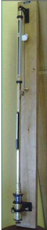
Baromètre de type Fortin
