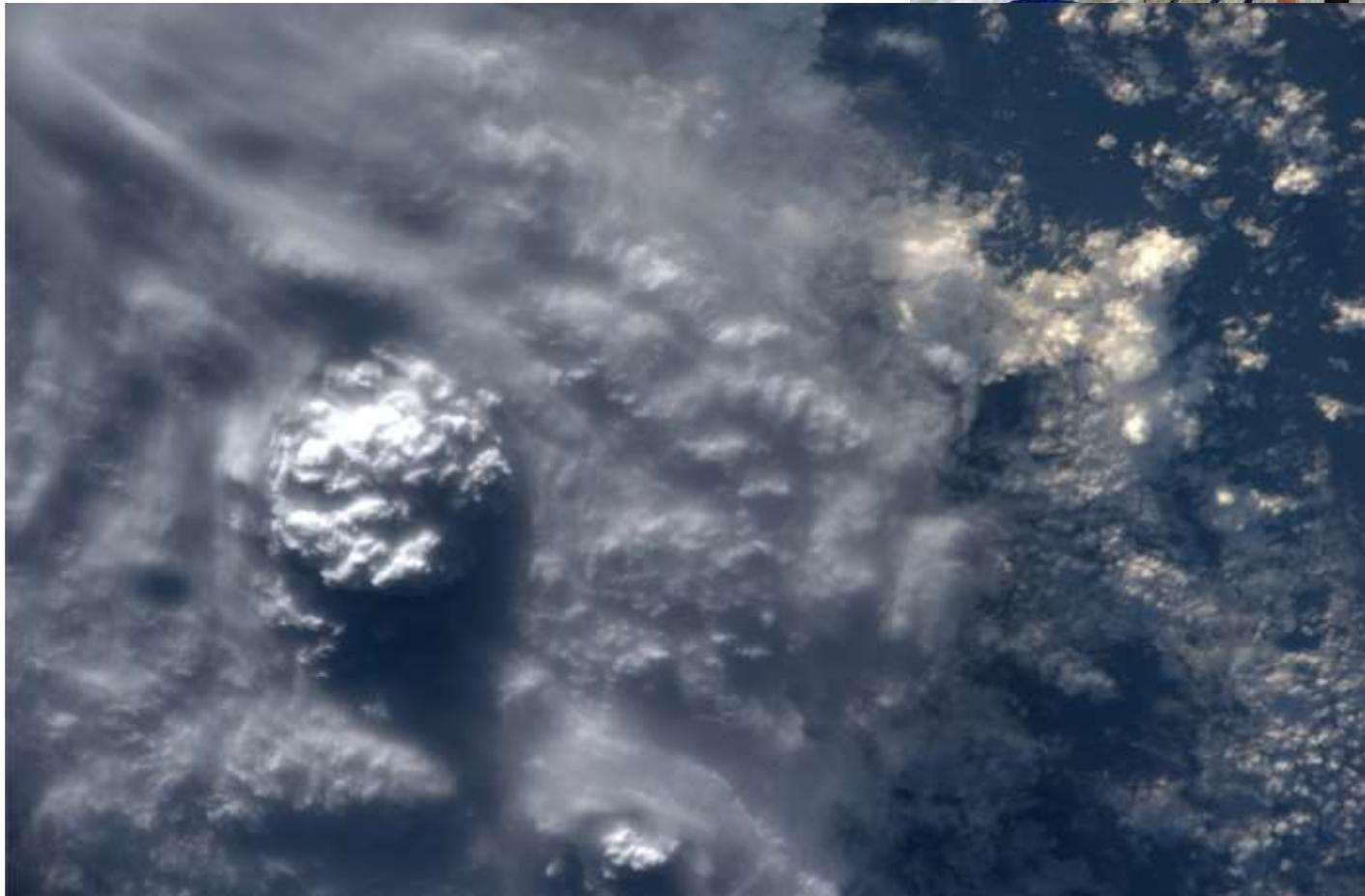
Un satellite avec un détecteur de rayonnement infrarouge peut distinguer les nuages bas (chauds) des nuages hauts (froids). En plus, les images IR sont disponibles jour et nuit. (Le radiomètre mesure la radiance émise à la longueur d'onde de 10,7 microns
