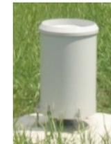
Pluviomètre à bascule
