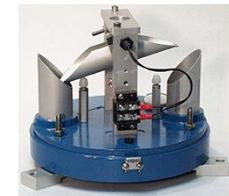
Après avoir recueilli 0,2mm, l'auger devient trop lourd et il bascule. Ce mouvement touche l'interrupteur qui envoie un signal.
