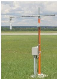
Il envoie une onde ultrason. En calculant le temps de l'écho, on connaît la hauteur d'accumulation de la neige.
