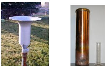
Le cornet sert à réduire la turbulence. La neige s'accumule dans le grand cylindre. La neige est fondue, puis on mesure la hauteur d'eau. Puis on multiplie par 10 pour obtenir la hauteur de neige.
