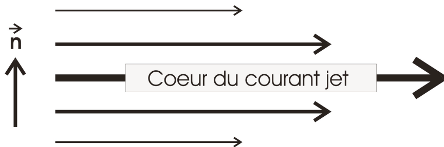
Figure 5. Représentation schématique du courant jet. Le cœur du courant jet correspond à l'axe de maximum de vitesse. Les vitesses diminuent en s'éloignant de cet axe. Le facteur de Coriolis f est positif (dans l'hémisphère nord) et le cisaillement du vent est négatif à gauche du cœur du courant jet et positif à sa droite.
